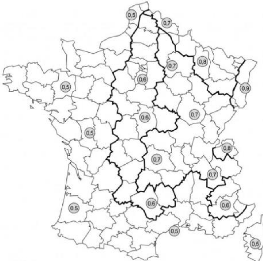
Figure 3-10 : Profondeur hors-gel des fondations
