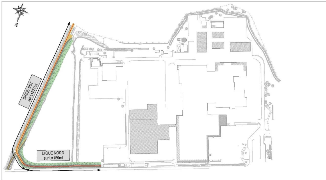
Figure 3-3 : Emplacement des digues de l'ARC à réaliser
